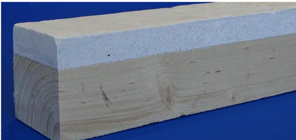
Verbund aus Holz und dem entwickelten Material, welches fast beliebig einfärbbar ist
